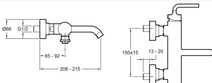
Спецификация продукта: Настенный смеситель для ванны/душа. E14589-4A. Коллекция: PURIST. Размеры (см): х х см. Вес: 3,5 кг. Расход воды: 23 л/мин при давлении 3 бар. Механизм: Последовательный керамический картридж. Разметка отверстий: 150 ± 15 мм.
